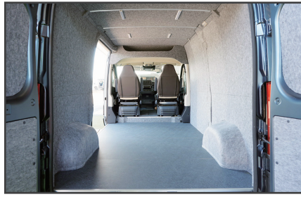
荷室 内装トリム施工 (天井・壁)
