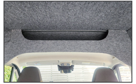
前席 内装トリム施工 (隔壁取外作業 / 荷室バー・オーバヘッドコンソール付)
